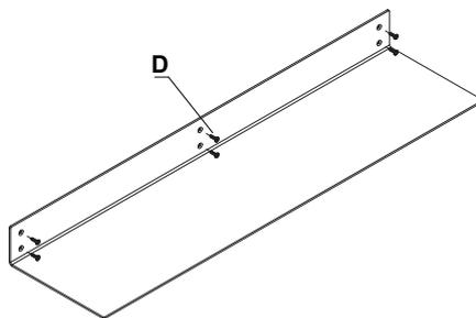
2. Use o tapa furo (D) para cobrir os parafusos.
