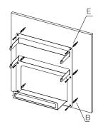
9. Para instalar o **Dispenser Organize**, utilize a ferragem **(C)** para fixação em MDF e as ferragens **(D)** e **(E)** para fixação em alvenaria. **Obs:** Este produto permite que o parafuso de fixação seja apertado todo, tornando-o fixo ou não seja apertado totalmente, permitindo a fácil remoção do local.
