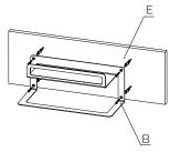
8. Para instalar o **Dispenser Organize para rolos e condimentos**, utilize a ferragem **(A)** para fixação em MDF e as ferragens **(B)** e **(E)** para fixação em alvenaria, conforme desenhos abaixo:
