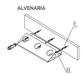
2. Para instalar a Adega Organize com suporte de taças, utilize a ferragem (A) para fixação em MDF e as ferragens (B) e (E) para fixação em alvenaria,
